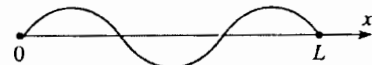
H.11. Dao động tự do của một sợi dây cố định ở hai đầu.
