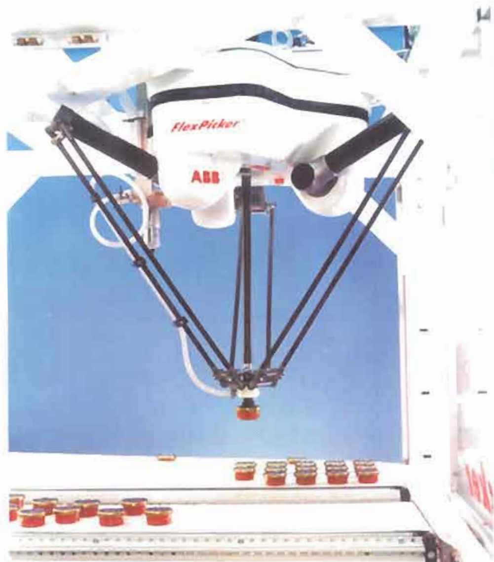
RBSS của Công ty ABB đang nhặt sản phẩm từ băng chuyền
