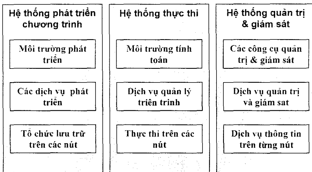
Hình 2-5 Kiến trúc phân hệ BKluster
