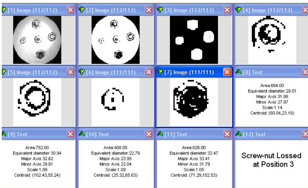
Hình 2.51: Kết quả xử lý kiểm tra đai ốc trên màn hình
