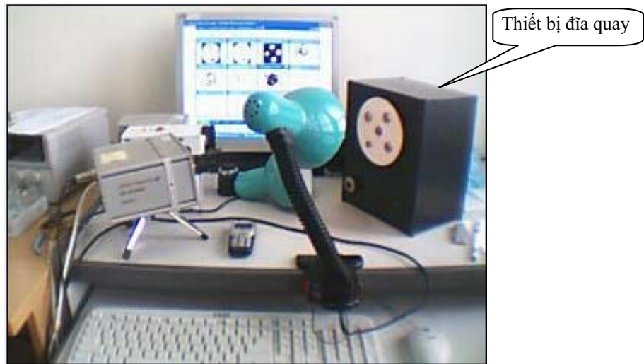
Hình 2.48: Mô hình thí nghiệm kiểm tra đại ốc
