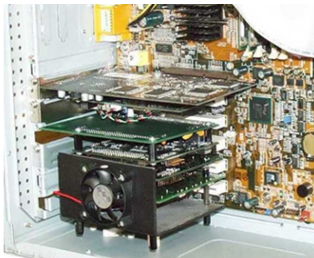
Hình 25: Máy tính thị giác trên PC104-plus Hình 26: Máy tính thị giác trên PC để bàn
