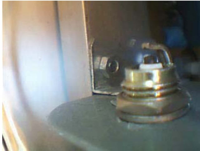
Hình 2.8. Đầu bu gi bật tia lửa điện
