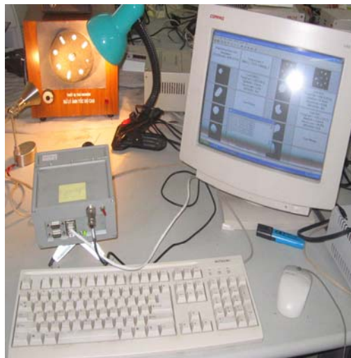
Hình 2.22. Hệ phân loại thuốc viên sử dụng công nghệ CNN trong phòng thí nghiệm
