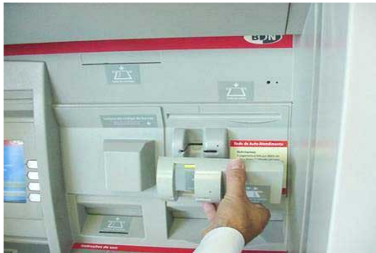
Thiết bị được cài đặt vào mặt trước của rãnh thẻ ATM.
