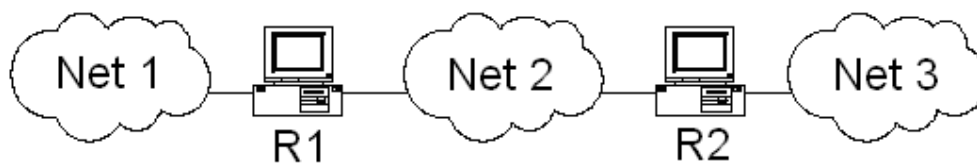
Hình 3: Ba mạng kết nối với nhau thông qua 2 router
